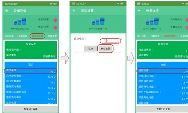
图 5-5 参数设置-超压电压设置
