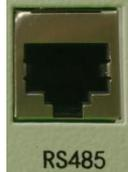
图 2-2 控制器设备 RJ45 接口（RS485 通信协议）
